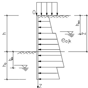
图 5.2.2 水平荷载标准值计算简图
