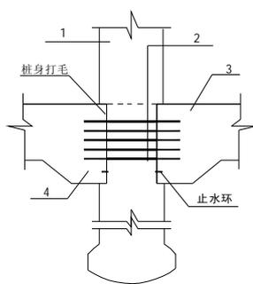
图 5.6.1 挖孔桩和基础底板的连接
