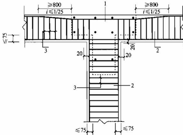
图 6.3.3-2 梁宽大于柱肢厚时的箍筋构造
