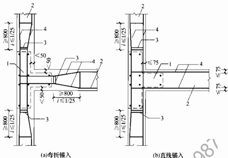
图 6.3.3-1 框架梁纵向钢筋锚入节点区的构造
