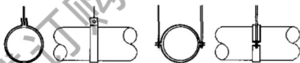
图 4.2.14 柔性风管吊卡箍安装
