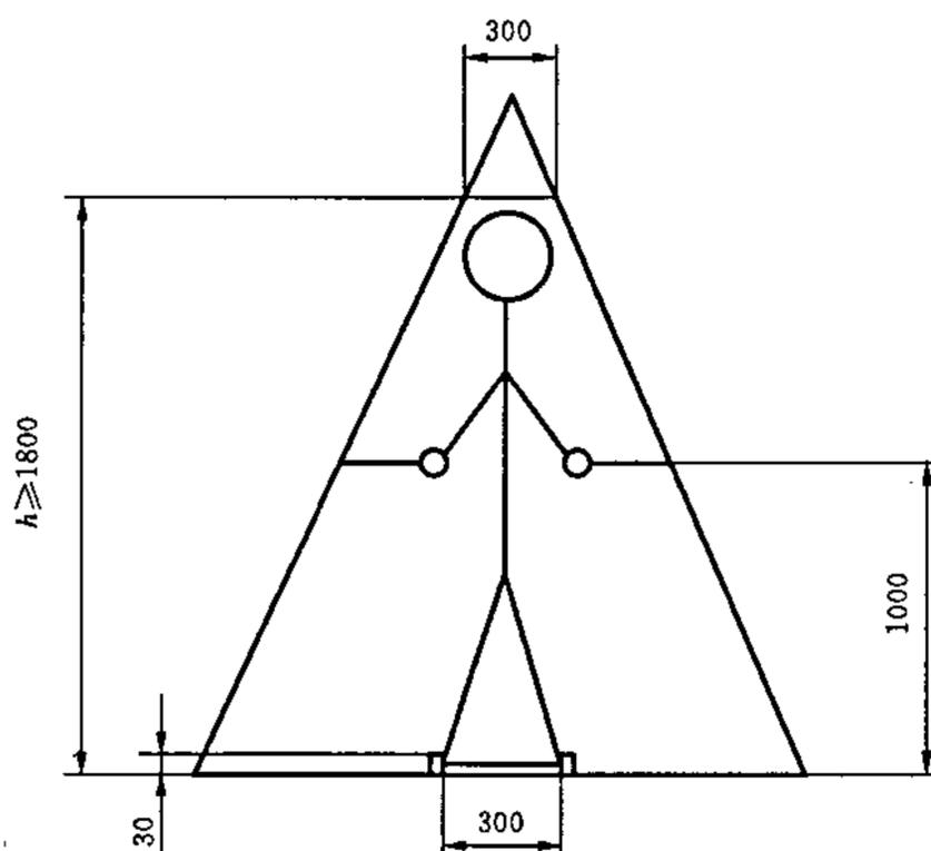
$h$ ——净空高度(为头和脚两平面内均能满足 300 mm 净宽度的前提下的高度)。
