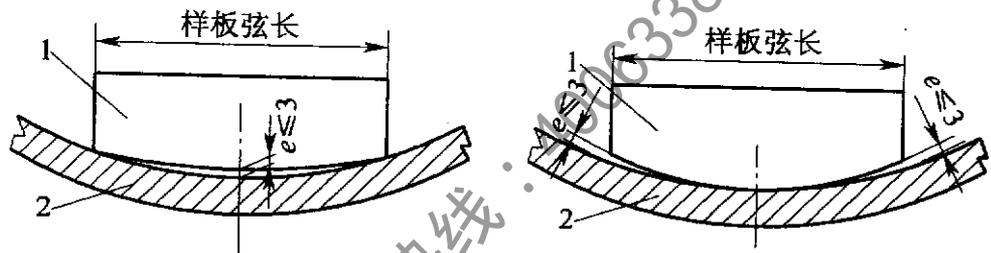
图 4.2.4-1 球壳板曲率检查(单位:mm)
