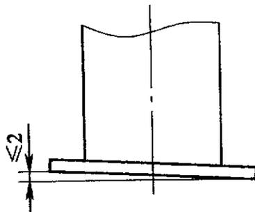
图 4.3.2 支柱与底板垂直度偏差(单位:mm)
