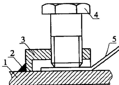
图 8.4.2 测温热电偶螺栓固定方法
