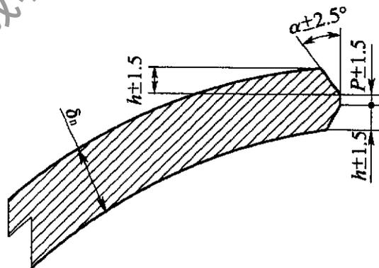
图 4.2.5 球壳板坡口几何尺寸(单位:mm)
