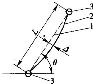
图 5.2.9 拉杆中部挠度的测定
