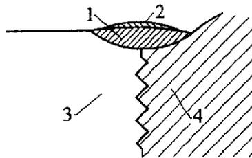
图 6.5.2-2 焊接修补的回火焊道
