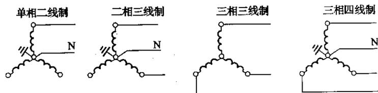
图 4 交流系统带电导体类型
